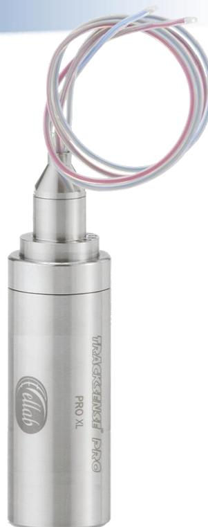
現在の TrackSense® Pro X ロガーは、拡張 (ロング) バージョンの Pro XL で利用可能となりました。長いハウジングの設計を取り入れ、容量の大きいリチウム電池 150L タイプを使用しています。ロガーは、非常に低い温度で改善された操作を提供します。 $-80^{\circ}\text{C}$  から  $+150^{\circ}\text{C}$  の温度範囲でバッテリー寿命が 50% 延長しました。長寿命電池容量により、高温から低温へ変化するアプリケーションで電池の安定性が特に増加しました。
